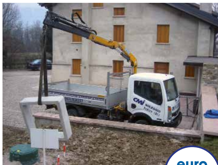
Autocarro 35 q.li con gru cassone ribaltabile 3,25x2 mt portata max 8,2 q.li
